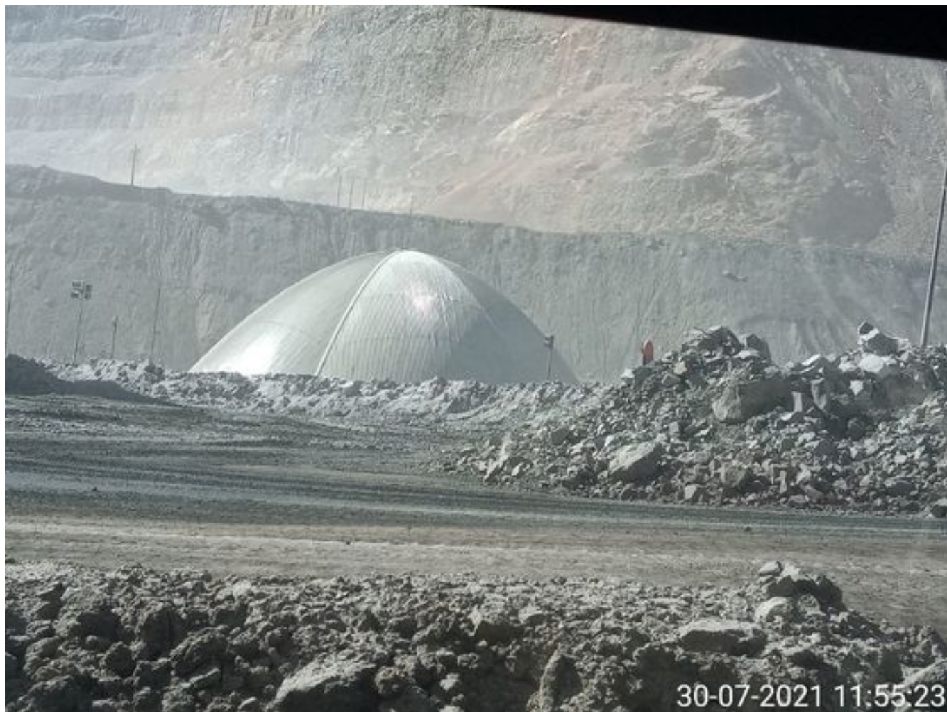
Foto 24: Medida: Espumante en Correas y Stock Pile. Lugar: Chancado 2. Comentarios: producto operativo no se observa material particulado fuera del domo
