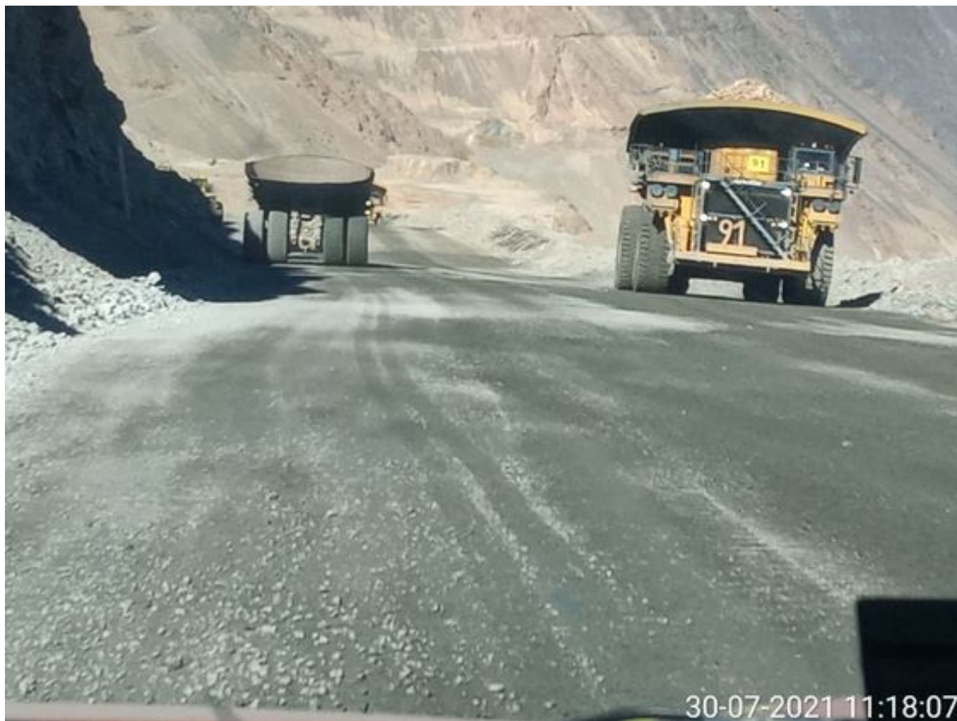
Foto 6: Medida: Riego de caminos. Lugar: Fases superiores. Comentarios: rampas con riego entre cortado con 2 camiones aljibes besalco (897 - 820 )y 2 cachimbas operativas, medida de regadío no es suficiente para mitigar material particulado, fuentes de emisión equipos de carguío y apoyo y tránsito de Caex, aljibes 810 y 817 sin proyección, 819 falla en potencia de motor y 814 fuera de servicio podría salir durante la tarde
