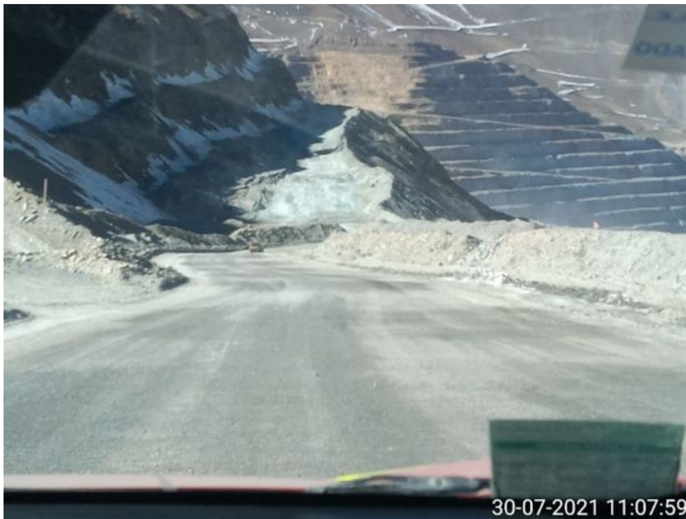
Foto 10: Medida: Riego de caminos EPSA Cerro Amarillo. Lugar: Fases superiores. Comentarios: rampas con riego entre cortado con 1 camión aljibe epsa operativo, fuente de emisión tránsito de Caex
