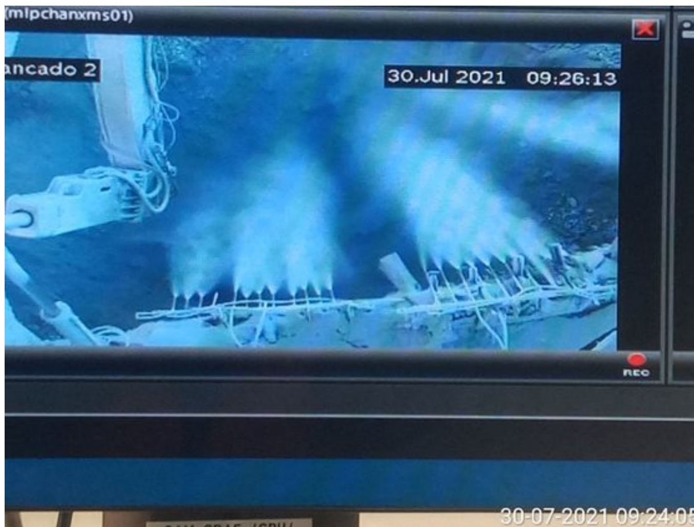
Foto 18: Medida: Supresor de polvo. Lugar: Taza Chancado 2. Comentarios: supresores se observan operativos pero medida no es suficiente para mitigar material particulado en descarga de caex en taza de chancado
